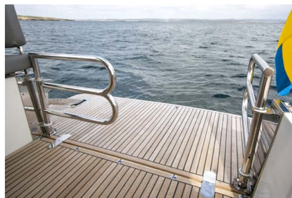
▲ Från akterdäcket når alla badsugna den stora badplattformen i samma nivå, genom att vika de B-formade grindarna åt sidan.
