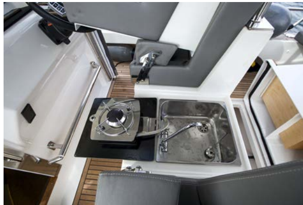
▲ Under mittstolen i den främre sitsraden döljer sig det minimala pentryt, med en liten ho med tryckvatten och en ensam gasolplatta.
